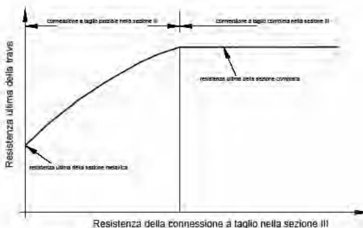
Figura C4.3.5 – Legame tra resistenza della trave e resistenza della connessione
